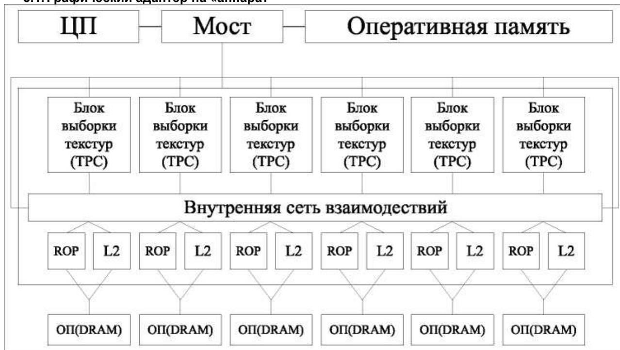
Рис. 2. Схематическое изображение устройства графического адаптера [3]
